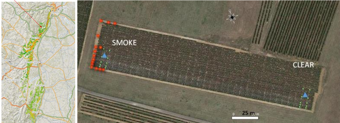
Figure 1 : Localisation de l'étude (à gauche) et plan du dispositif expérimental de la première expérience (le 22 février 2020). Etoiles rouges : position des bottes de paille ; points verts : position des capteurs de température ; triangle bleu : position des deux stations climatiques.
